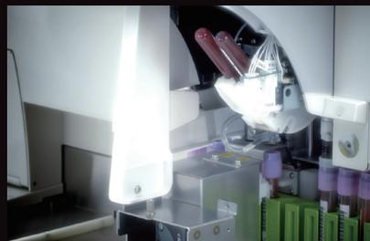
Cada tubo es sujetado uno por uno por el brazo robótico y es mezclado suavemente por inversión completa. El sistema de carga automática contribuye con la rapidez del reporte, favorece la toma de decisiones y hace más eficiente el flujo de trabajo del laboratorio.
